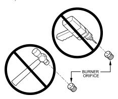
Fig. 64 - Orifice Hole
