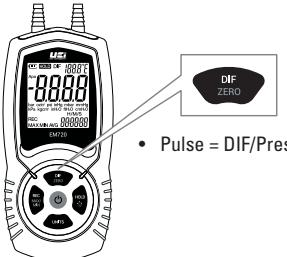
**NOTA:** Antes de utilizarse, el manómetro debe ajustarse a cero. Para hacer esto, cerciórese de que el manómetro esté en un área despresurizada y que no haya mangas conectadas. El manómetro tiene una cuenta regresiva de 10 segundos al encenderse.
