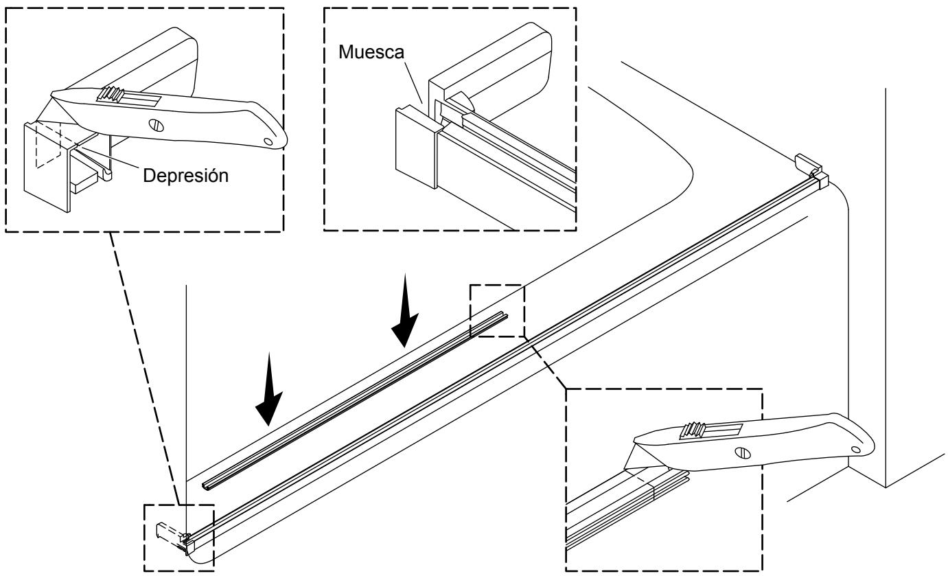
**⚠ PRECAUCIÓN: Riesgo de daños al producto.** Se requiere una muesca solo en el tope para el lado del panel fijo. Una depresión en la parte superior interior del tope indica dónde se debe recortar la muesca. **No recorte una muesca en el tope del lado del panel corredizo.**
