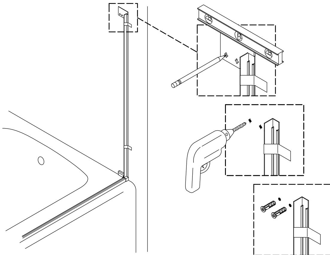
**IMPORTANT!** Le joint d'étanchéité mural doit être de niveau et d'aplomb pour une installation de linteau appropriée.
