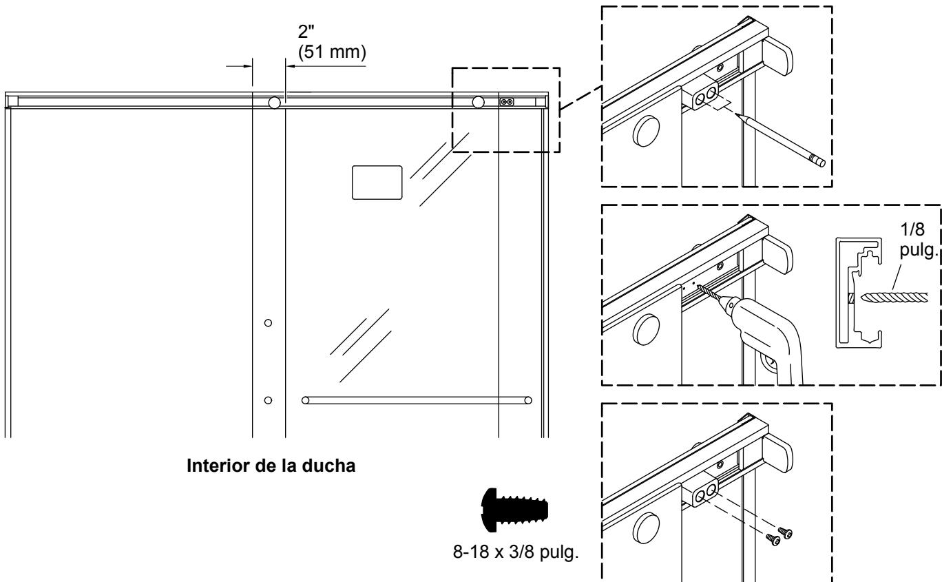
**NOTA:** Se requiere un tope superior para las puertas de 54" (1372 mm), 66" (1676 mm) y 72" (1829 mm). Instale el tope superior, si se incluye. Si no se incluye, pase a la siguiente sección.
