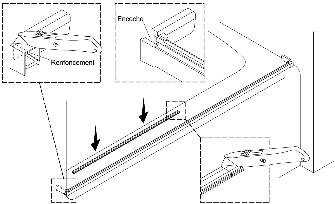
**ATTENTION : Risque d'endommagement du produit.** A notch is required on the bumper for the fixed panel side only. Un renforcement sur le dessus intérieur du butoir indique l'emplacement où l'encoche doit être découpée. Ne pas découper une encoche dans le butoir du panneau coulissant.
