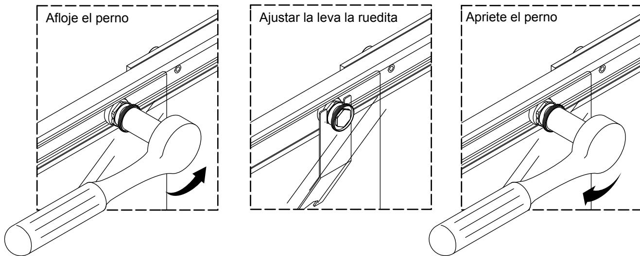
**AVISO:** Es posible que sea necesario ajustar los paneles para asegurar que hagan contacto con los topes superiores e inferiores en la posición cerrada.
