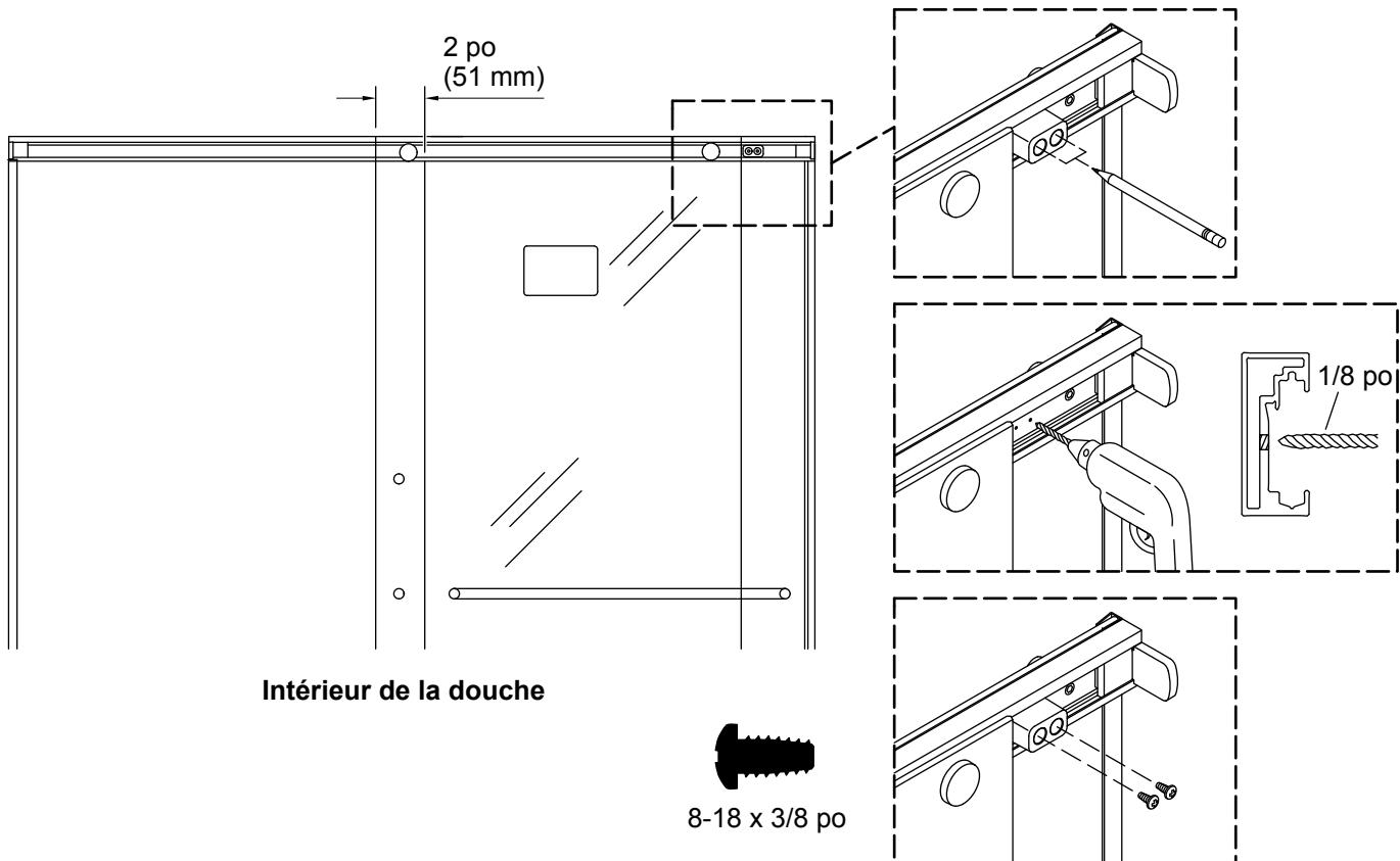
**REMARQUE :** Le butoir supérieur est requis pour les tailles de portes de 54 po (1372 mm), 66 po (1676 mm), et 72 po (1829 mm). Installer le butoir supérieur s'il est fourni. S'il n'est pas fourni, passer à la section suivante.
