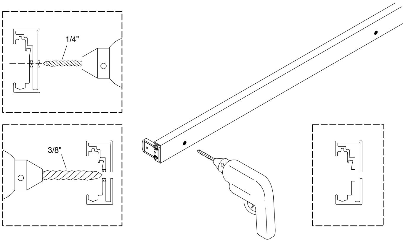
**⚠ ATTENTION : Risque de blessures.** Placer les mains loin des emplacements de perçage lors du perçage à travers le linteau.
