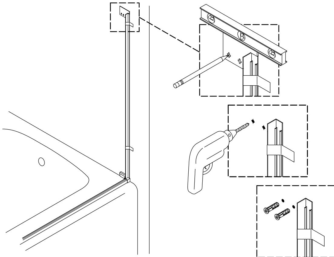
**¡IMPORTANTE!** El sello de pared debe estar nivelado y a plomo para poder instalar bien el dintel.
