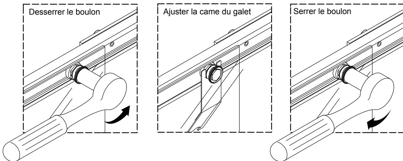
**AVIS :** Les panneaux pourraient nécessiter un ajustement pour assurer qu'ils touchent les butoirs du haut et du bas dans la position fermée appropriée.
