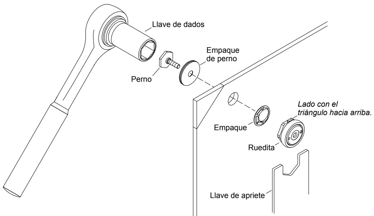
**AVISO:** Hay una figura de triángulo moldeada en una de las caras planas de cada ruedita.
