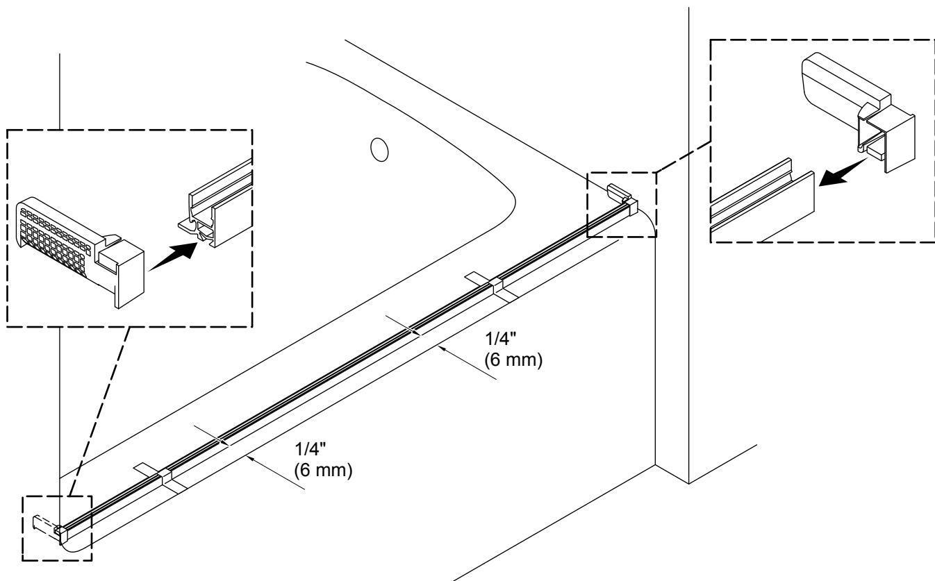
**AVIS :** Le seuil doit reposer sur une surface plate.
