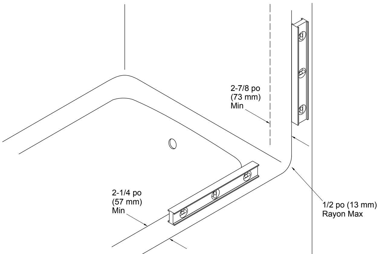
**IMPORTANT!** Pour un alignement et un fonctionnement adéquats, vérifier que la base de la douche/rebord de la baignoire et les murs sont conformes aux conditions requises suivantes. Ne pas installer la porte si ces conditions requises ne sont pas présentes.
