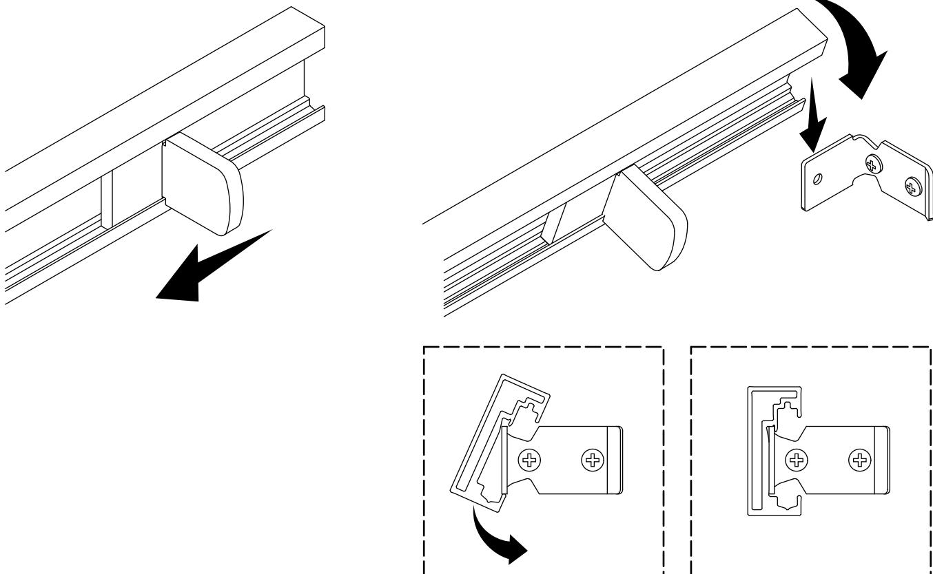
**⚠ PRECAUCIÓN: Riesgo de ocasionar daños al producto.** El dintel podría caerse si no se coloca correctamente en las ménsulas de pared. Verifique que la parte superior del dintel quede bien enganchado en las ménsulas.
