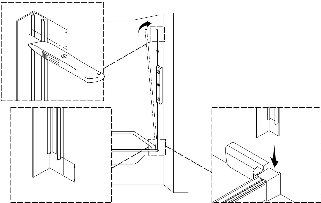
**¡IMPORTANTE!** El sello de pared debe estar nivelado y a plomo para poder instalar bien el dintel.
