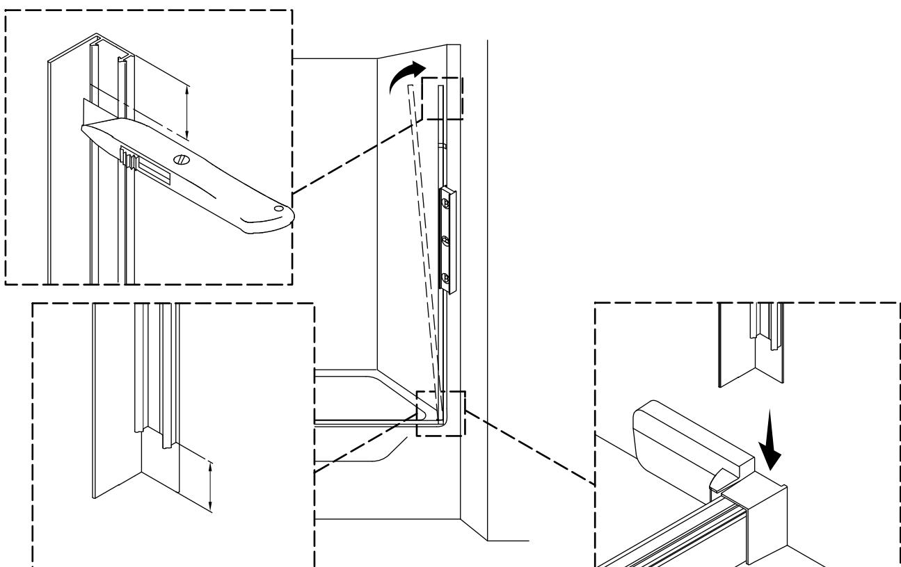
**IMPORTANT!** Le joint d'étanchéité mural doit être de niveau et d'aplomb pour une installation de linteau appropriée.
