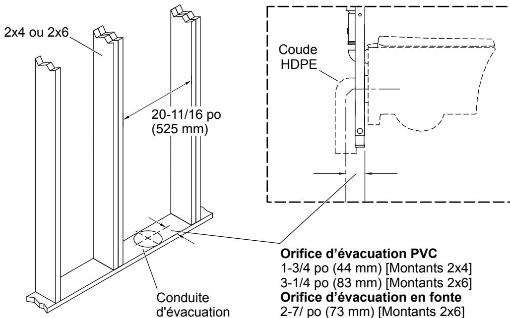
**IMPORTANT!** La dimension de la conduite d'évacuation entre le bord avant de la charpente et le centre de la conduite d'évacuation est de première importance pour cette installation. Se reporter à l'illustration ci-dessus et voir les options d'installation de la conduite d'évacuation dans la section « Avant de commencer » pour obtenir des détails supplémentaires.
