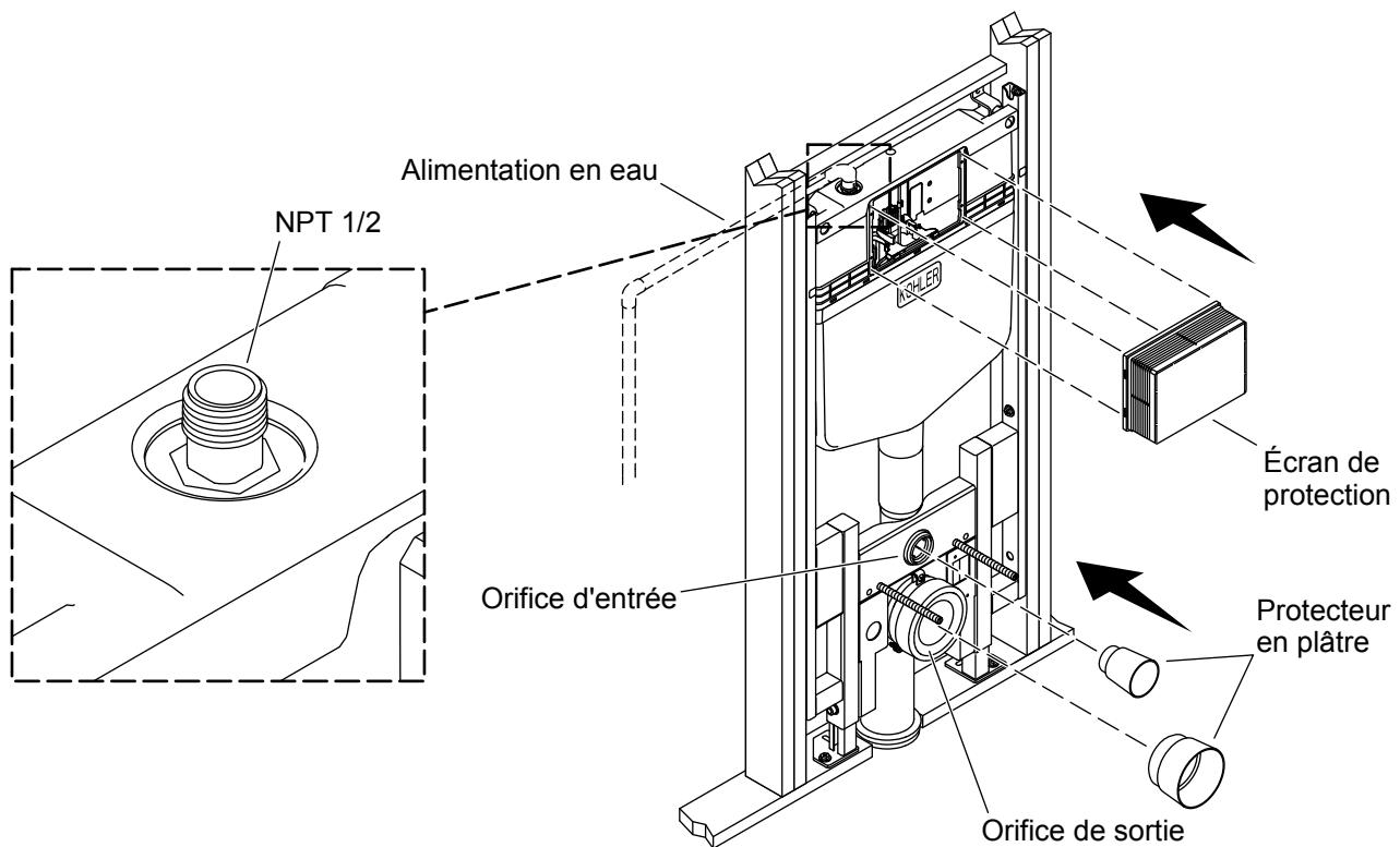
**REMARQUE :** L'orifice d'entrée de la vanne du réservoir utilise des filets NPT 1/2.
