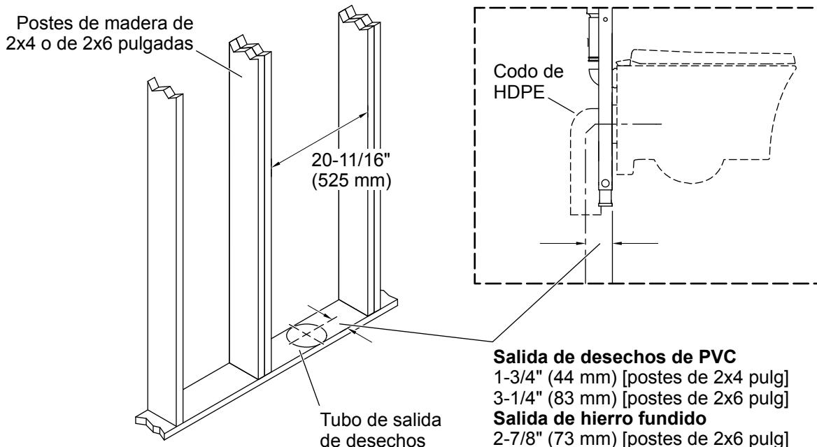
**¡IMPORTANTE!** La dimensión del tubo de salida de desechos desde el borde delantero de la estructura de postes de madera hasta el centro del tubo de salida de desechos es crítica para esta instalación. Consulte la ilustración anterior, y vea más detalles de las opciones de instalación de tubos de desechos en "Antes de comenzar".
