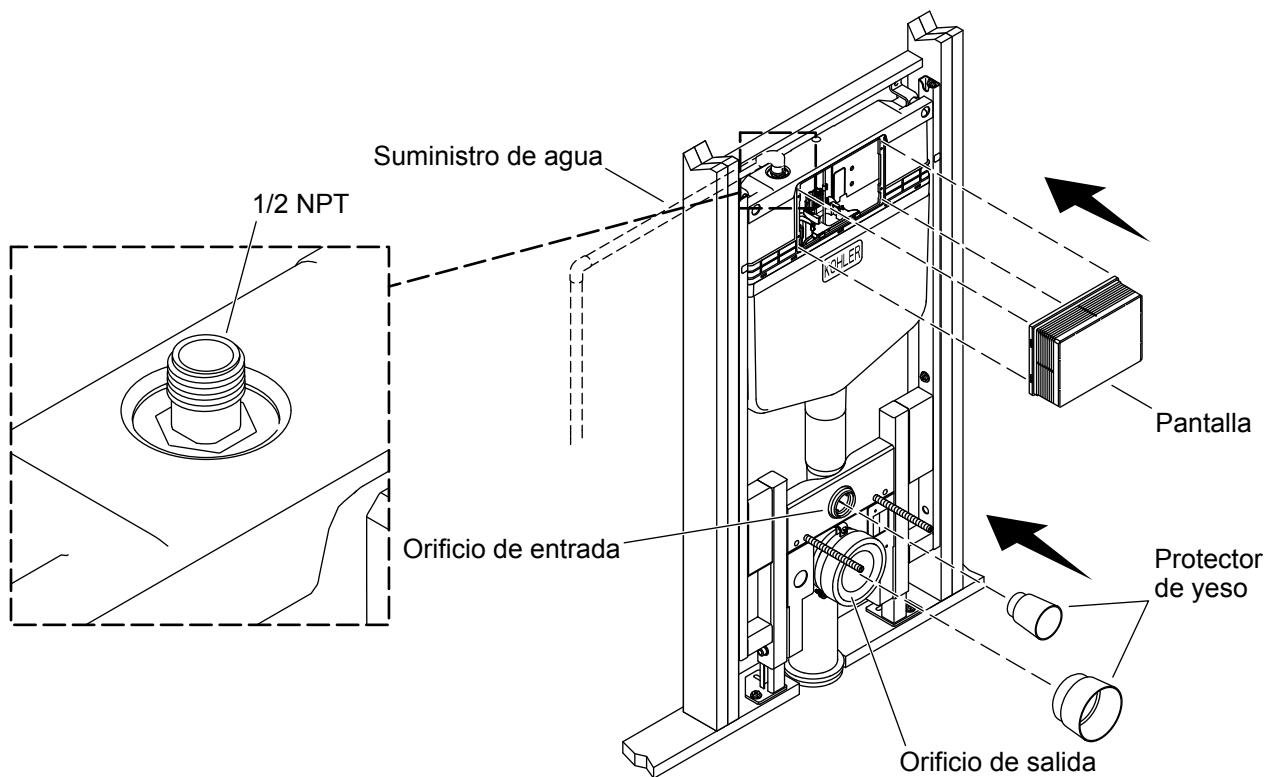
**NOTA:** La entrada a la válvula del tanque tiene rosca 1/2 NPT.
