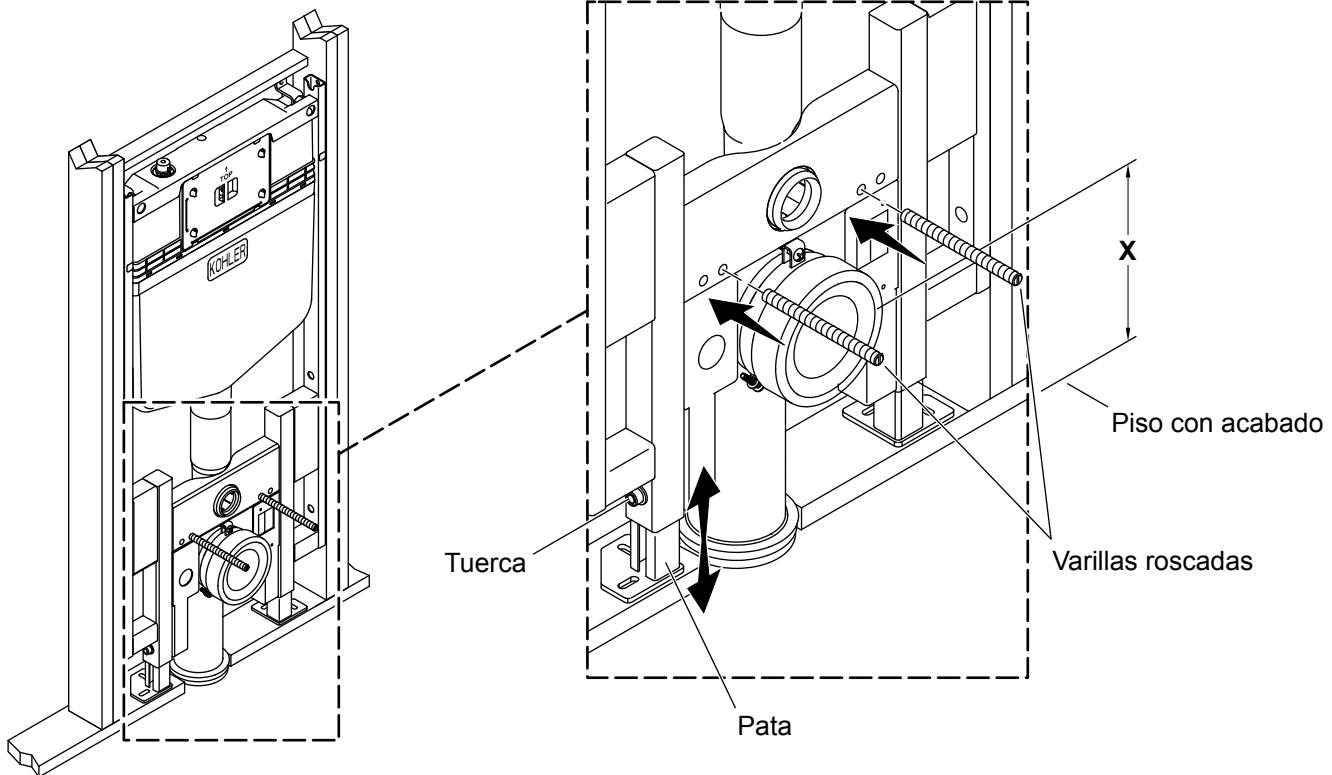
**¡IMPORTANTE!** Si el armazón no ha sido bien ajustado, es posible que la altura del reborde de la taza del inodoro no se ajuste a los códigos pertinentes. Si la altura de la taza del inodoro no es la correcta, se debe retirar la pared acabada para hacer los ajustes necesarios.
