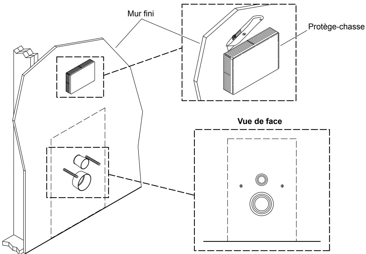
**ATTENTION : Risque d'endommagement du produit.** Ne pas perforez le réservoir d'eau avec les dispositifs d'attache. Utiliser le modèle pour déterminer les emplacements des dispositifs d'attache pour fixer le mur fini en place. Suspendre ce modèle sur l'écran de la chasse pour identifier l'emplacement du réservoir.
