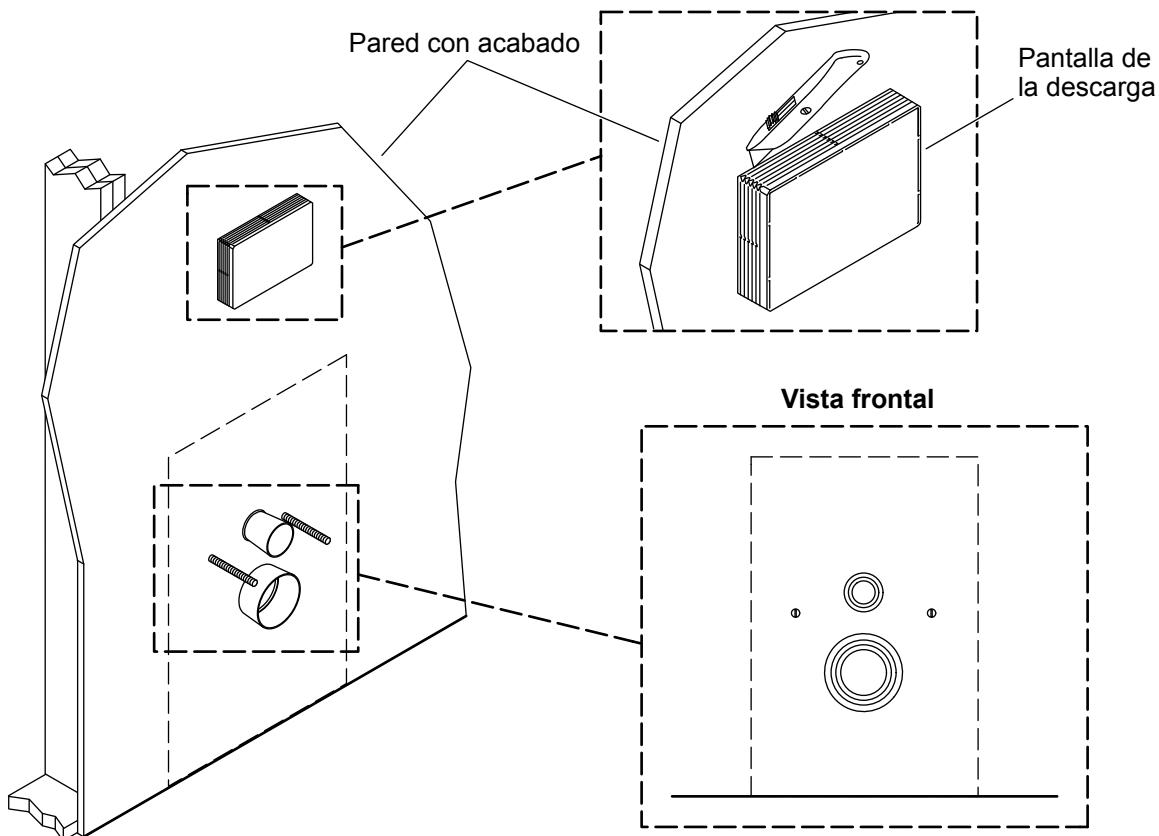
**⚠ PRECAUCIÓN: Riesgo de daños al producto.** No perfore el tanque de agua con los sujetadores. Determine la ubicación de los sujetadores para fijar la pared acabada mediante la plantilla. Cuelgue esta plantilla en la pantalla de descarga para identificar la ubicación del tanque.
