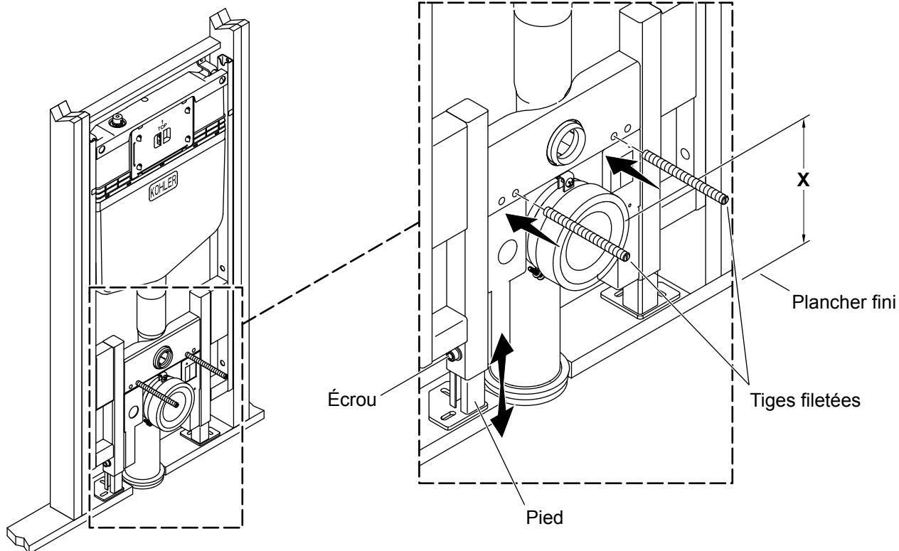
**IMPORTANT!** Si le bâti-support n'a pas été ajusté correctement, la hauteur du rebord de cuvette peut ne pas être conforme aux codes en vigueur. Si la hauteur de la cuvette n'est pas correcte, il sera nécessaire de retirer le mur fini pour effectuer les ajustements nécessaires.
