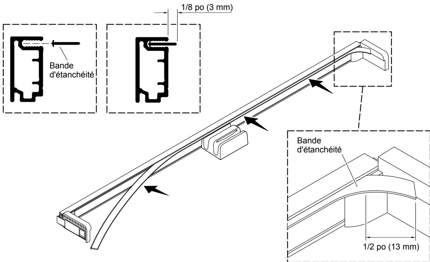
**IMPORTANT!** Le joint d'étanchéité doit être installé avec  $1/2 \text{ po (13 mm)}$  au moins se prolongeant au-delà de chaque extrémité du seuil. Le joint d'étanchéité sera coupé pour être adapté une fois que le seuil sera installé.
