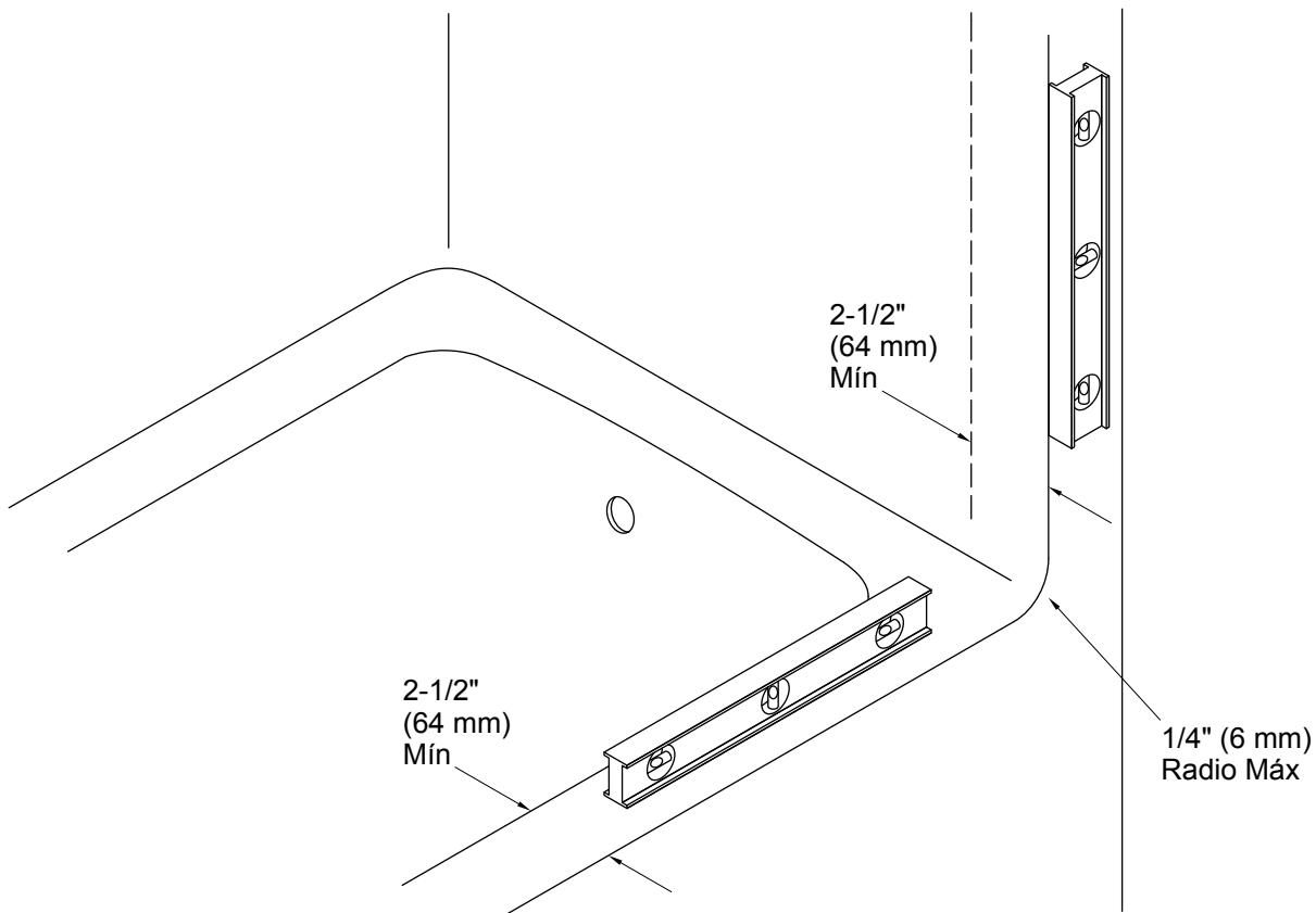
**¡IMPORTANTE!** Para asegurar la alineación y el funcionamiento correctos, confirme que la base de la ducha o el reborde de bañera y las paredes cumplan los siguientes requisitos. No instale la puerta si no se cumplen estos requisitos.
