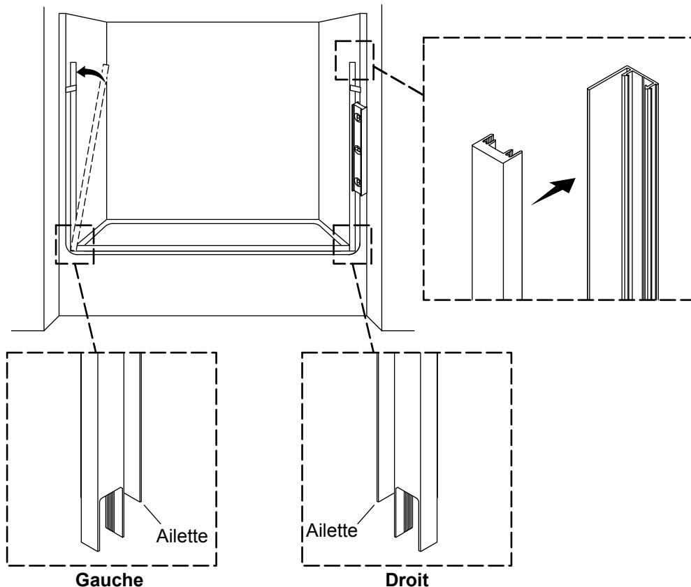
**REMARQUE :** L'ailette flexible du joint d'étanchéité se trouve sur l'intérieur des montants de mur.
