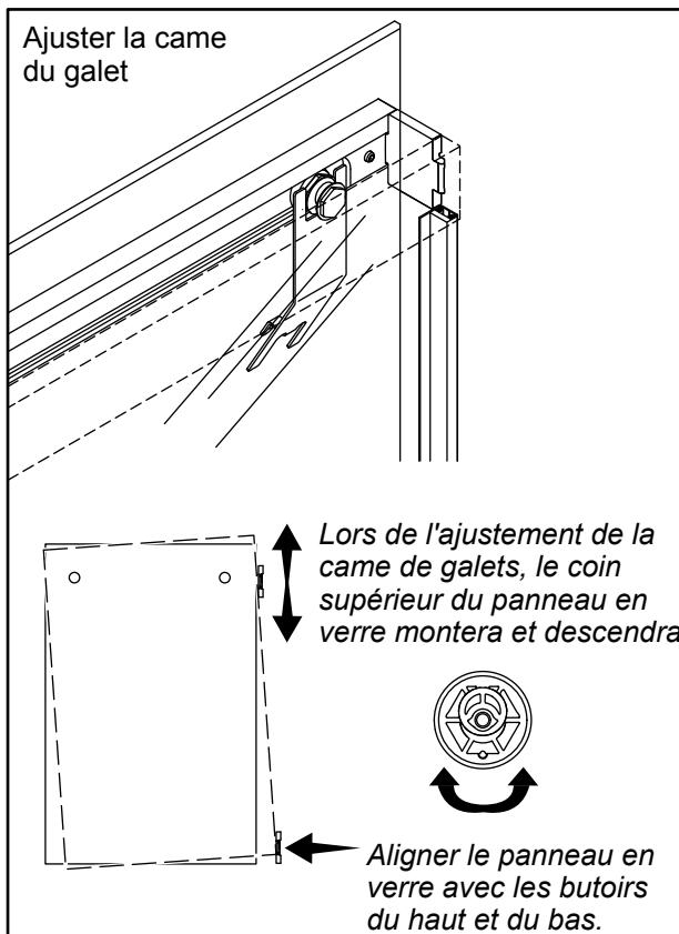
**AVIS :** Les panneaux pourraient nécessiter un ajustement pour assurer qu'ils touchent les butoirs du haut et du bas dans la position fermée appropriée. Le panneau intérieur doit se fermer sur le côté pomme de douche, et le panneau extérieur doit se fermer sur le côté opposé. Un ajustement est effectué le plus facilement lorsque le panneau est fermé contre le mur de douche correct.
