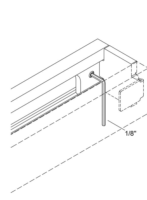
**NOTA:** Para facilitar la instalación de los topes, es posible que sea necesario aflojar los conectores de los dinteles y alejarlos temporalmente del soporte.
