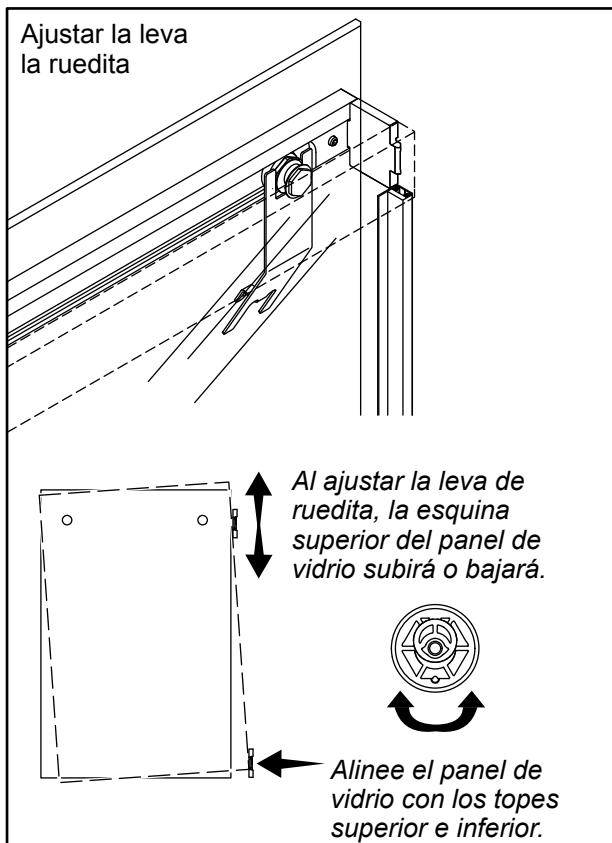
**AVISO:** Es posible que sea necesario ajustar los paneles para asegurar que hagan contacto con los topes superiores e inferiores en la posición cerrada. El panel interior debe cerrar del lado de la cabeza de ducha, y el panel exterior debe cerrar en el lado opuesto. Se facilita hacer los ajustes cuando se hacen con el panel cerrado contra la pared correcta de la ducha.
