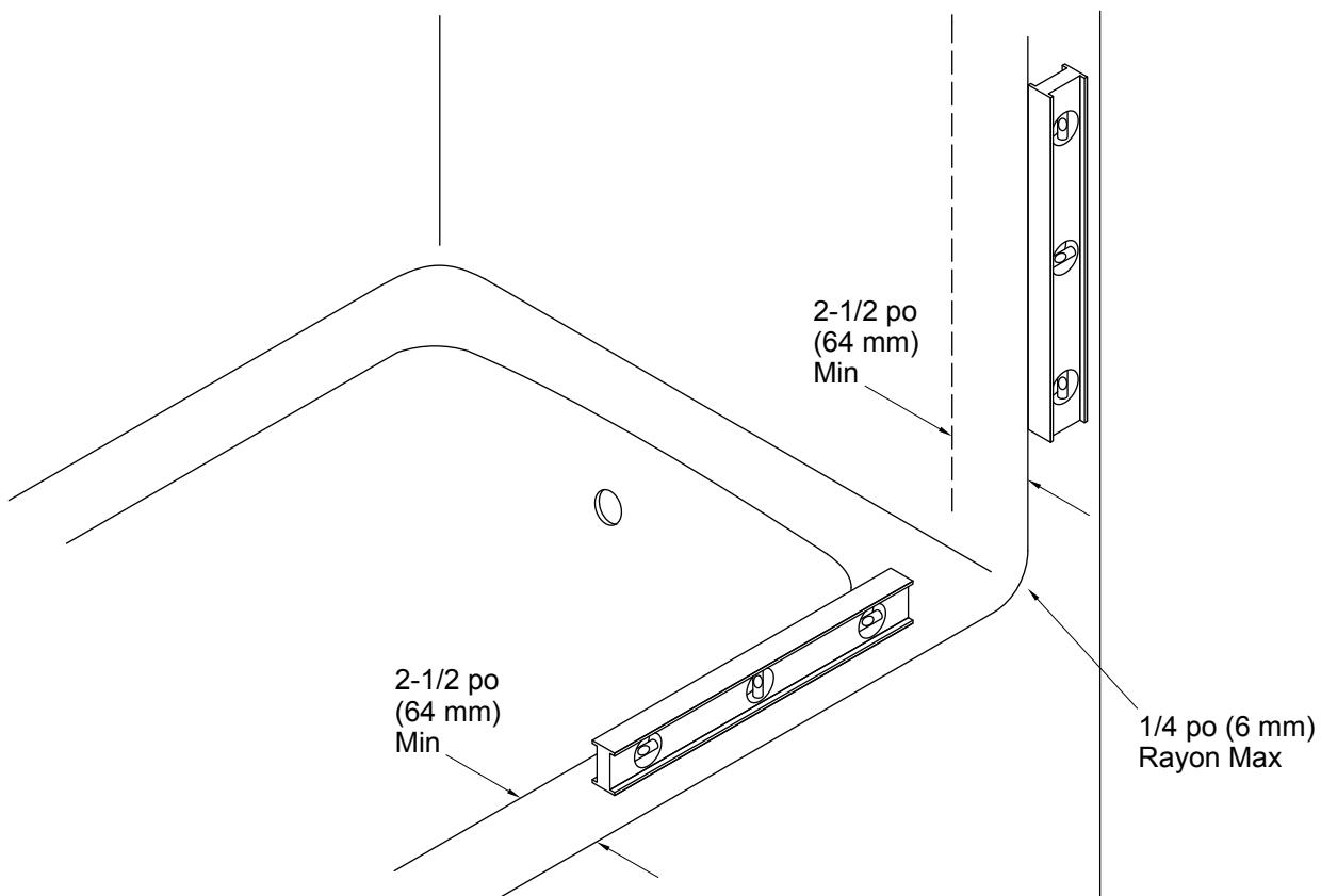
**IMPORTANT!** Pour un alignement et un fonctionnement adéquats, vérifier que la base de la douche/le rebord de la baignoire et les murs sont conformes aux conditions requises suivantes. Ne pas installer la porte si ces conditions requises ne sont pas présentes.
