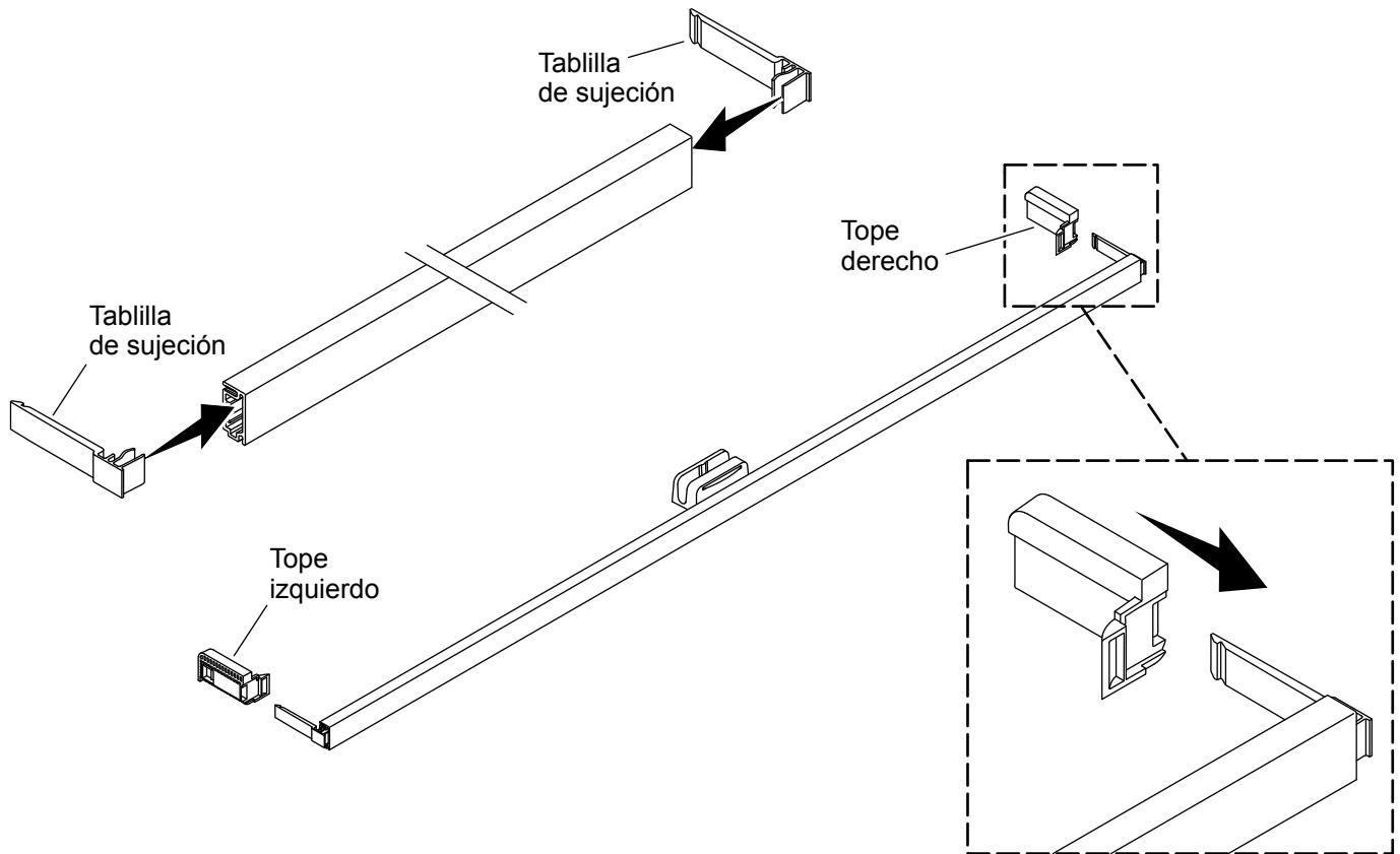
**NOTA:** Hay un tope para el lado izquierdo y otro para el derecho. Las tablillas de sujeción son idénticas.
