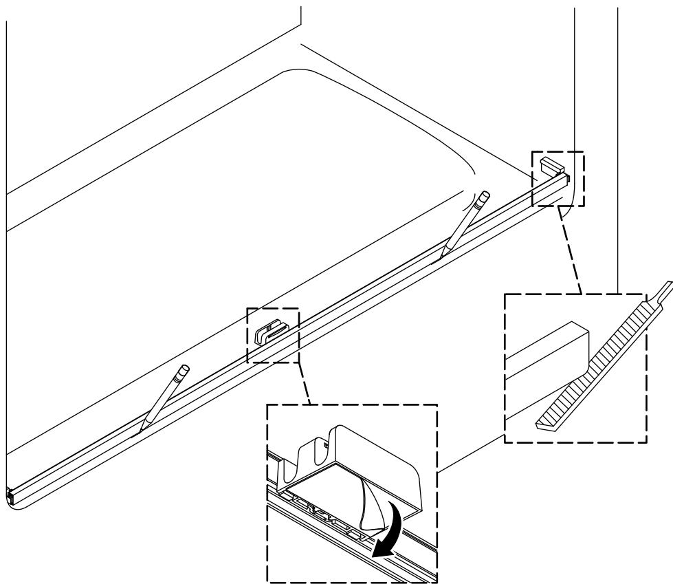
**AVIS :** Le seuil doit reposer sur une surface plate.
