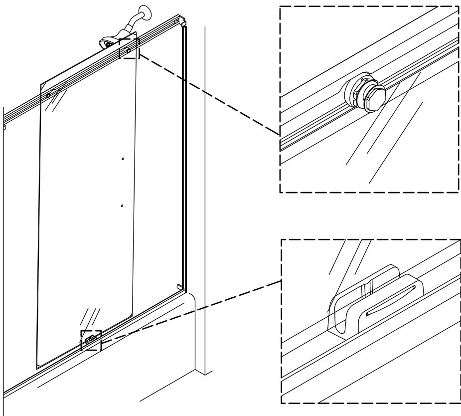
**⚠ PRECAUCIÓN: Riesgo de daños al producto.** Una vez instalado, no mueva el panel cercano a la pared porque los topes superiores no han sido instalados en este momento.
