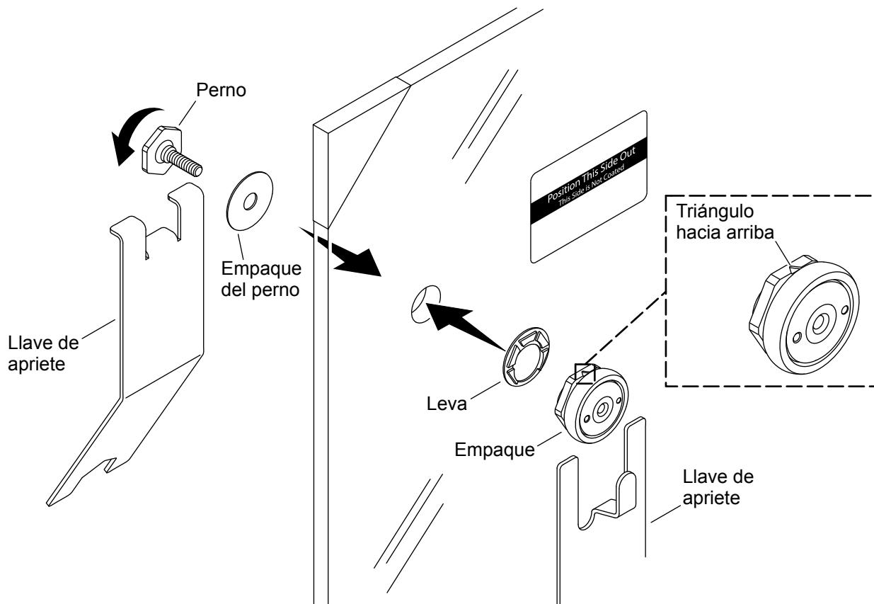
**AVISO:** Hay una figura de triángulo moldeada en una de las caras planas de cada ruedita.
