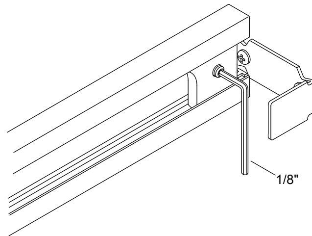
**¡IMPORTANTE!** En este paso se fija el dintel a los soportes, de forma que se pueda colgar el panel de la puerta.
