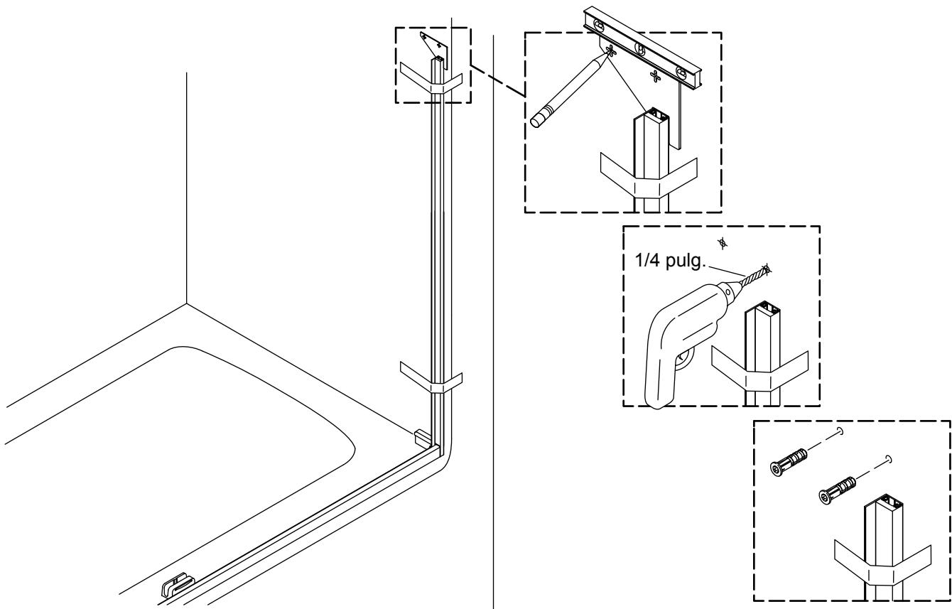
**¡IMPORTANTE!** La ubicación de los orificios para los soportes murales es crítica. Asegúrese de que los orificios estén correctamente marcados y taladrados perpendiculares a la pared.
