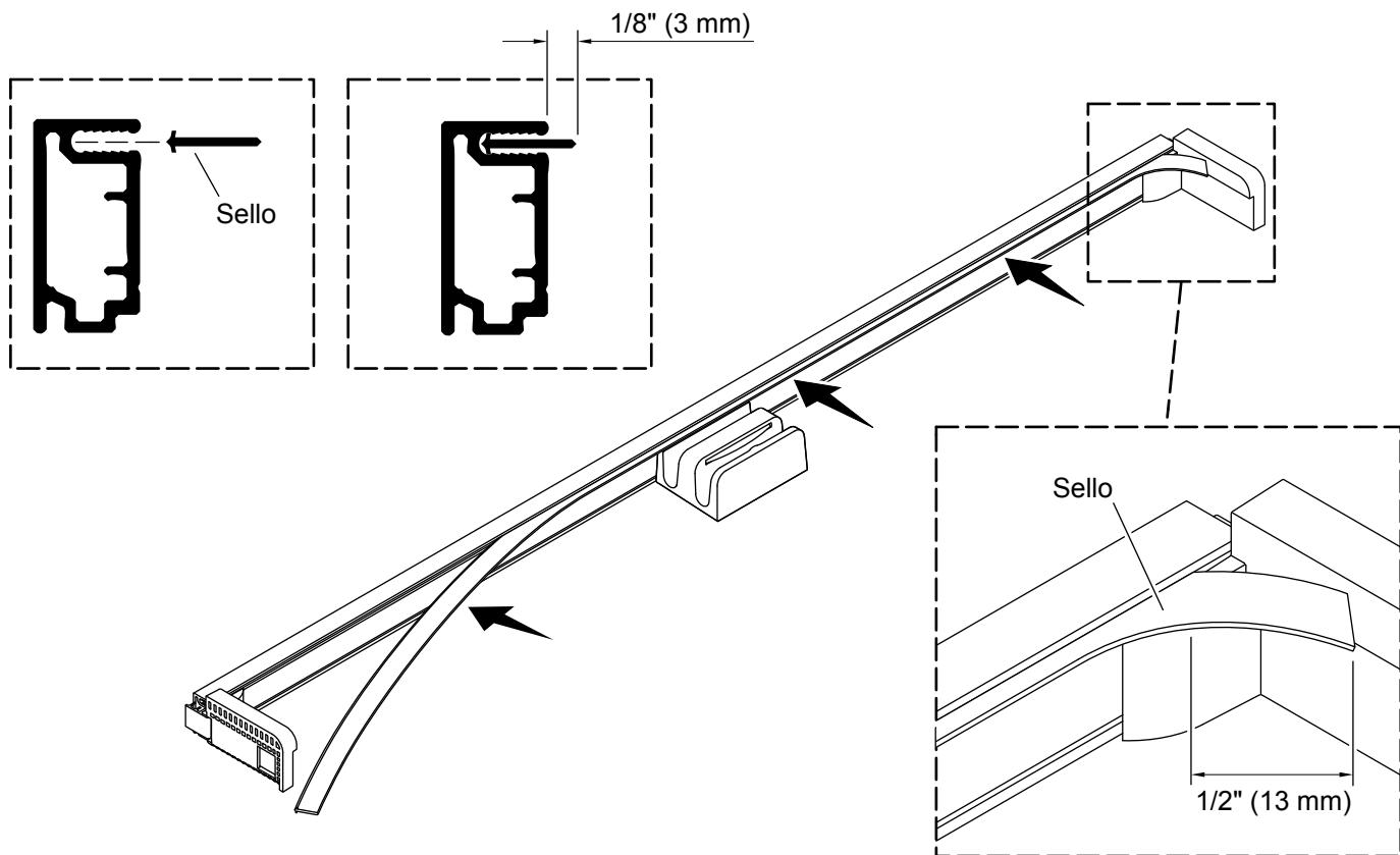
**¡IMPORTANTE!** El sello debe instalarse con por lo menos 1/2" (13 mm) sobresaliendo de cada extremo del umbral. El sello se cortará a que ajuste, después de que se haya instalado el umbral.
