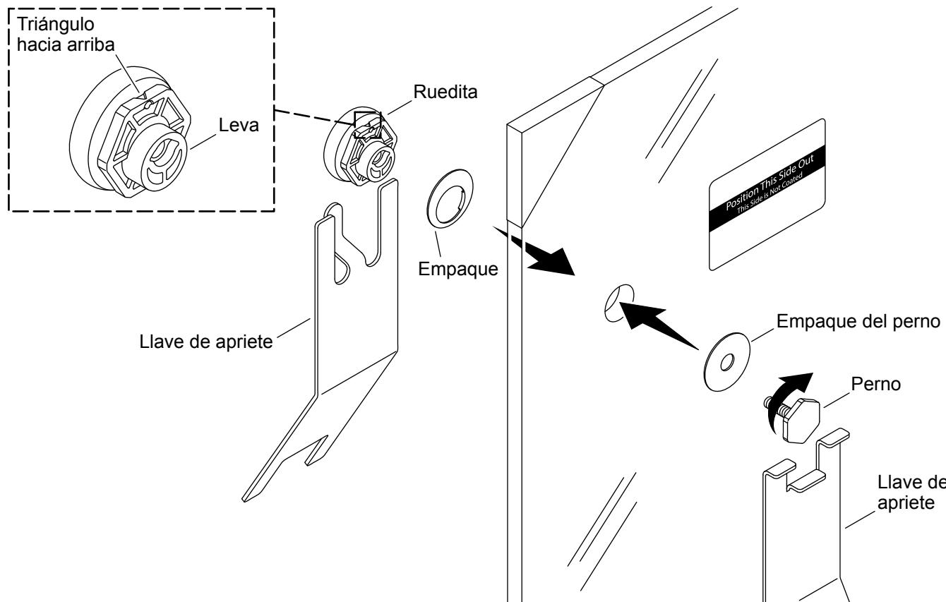
**AVISO:** Hay una figura de triángulo moldeada en una de las caras planas de cada ruedita.
