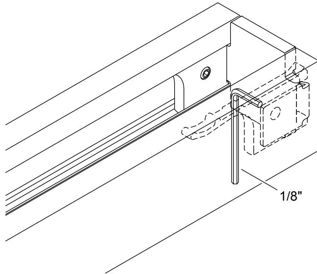
**¡IMPORTANTE!** En este paso se fija el dintel a los soportes, de forma que se pueda colgar el panel de la puerta.
