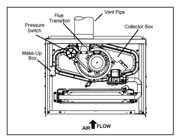
Figure 15. Upflow Position Top Vent Discharge
